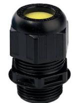
**Ex-Reduzierung, Material Polyamid, Dichtung EPDM, Temp. -40°C/+75°C, Schutzart IP66 / IP68 (5 bar 30 min) IECEx / ATEX Zündschutzart Ex eb, Ex tb**
