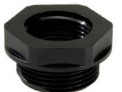
**Ex-Erweiterung, Material Polyamid, Dichtung EPDM, Temp. -40°C/+75°C Schutzart IP66 / IP68 (5 bar 30 min) IECEx / ATEX Zündschutzart Ex eb, Ex tb**
