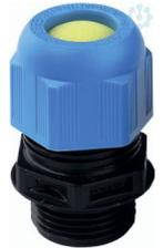
**Ex-Kabelverschraubung Gewinde kurz , Material Polyamid, Temp. -40°C/+75°C, Schutzart IP66 / IP68 (5 bar 30 min), IECEx / ATEX Zündschutzart Ex eb, Ex tb**
